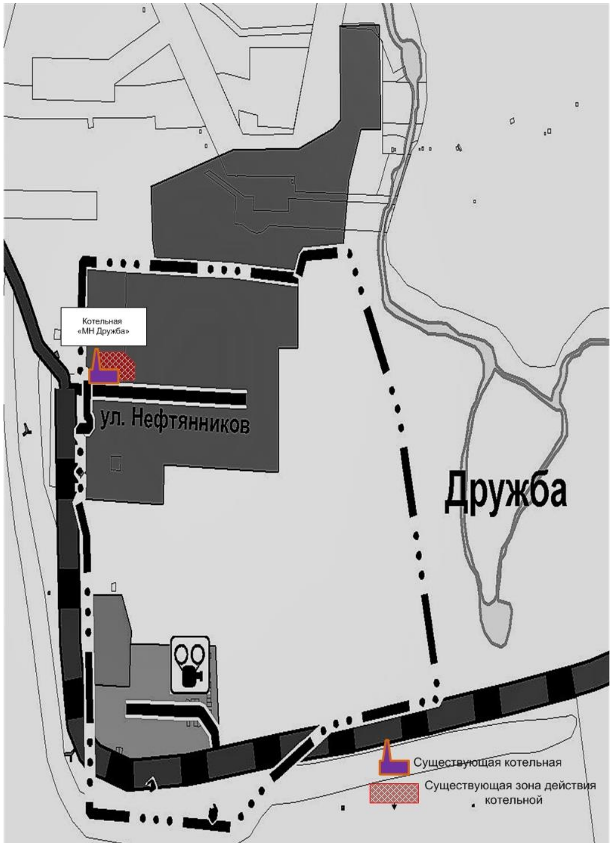
Рисунок 8 - Существующие зоны теплоснабжения от котельной п. Дружба
